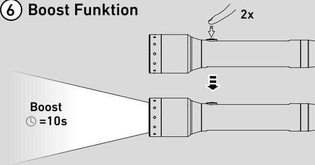
6. Im Boost-Modus leuchtet die Lampe mit der maximal möglichen Helligkeit für eine Dauer von zehn Sekunden. Der Boost Modus kann, außer bei eingeschalteter Tastensperre, jederzeit mit einem doppelten Antippen des Schalters aktiviert werden. Nach zehn Sekunden schaltet die Lampe in die zuvor ausgewählte Lichtfunktion zurück.
