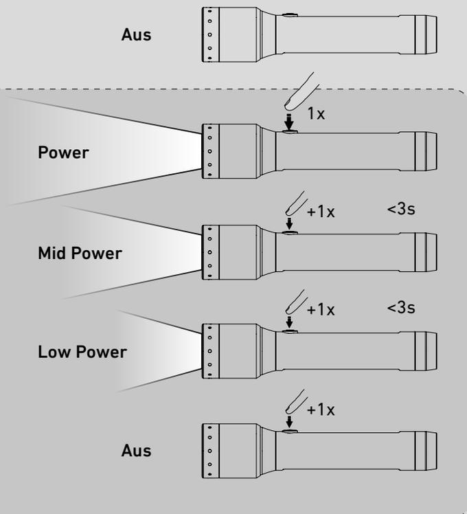
5. Diese Lampe verfügt über mehrere Lichtfunktionen oder Helligkeitsstufen.
