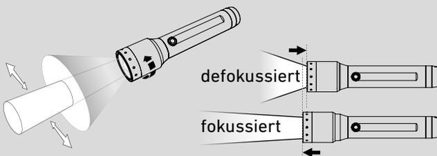
7. Verschiedene Aktivitäten erfordern unterschiedliches Licht. Durch leichtes Drehen und gleichzeitiges Vor- oder Zurückschieben des Lampenkopfes kann das Licht für maximale Leuchtwerte fokussiert (gebündelt) werden oder für gleichmäßige Ausleuchtung des Nahbereichs defokussiert werden.
