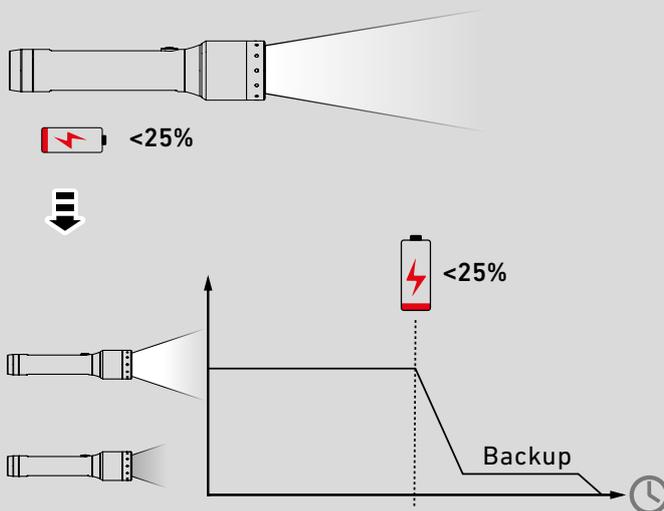
8. Bei niedriger verbleibender Akkukapazität – nach Ablauf der regulären Laufzeit – schaltet die Lampe in den „Backup Mode“. In diesem Modus kann die Lampe nur in der niedrigsten Helligkeitsstufe genutzt werden. Er verhindert ein plötzliches Ausschalten der Lampe und stellt sicher, dass der Anwender bei schwachem Akku weiterhin Licht zur Verfügung hat.
