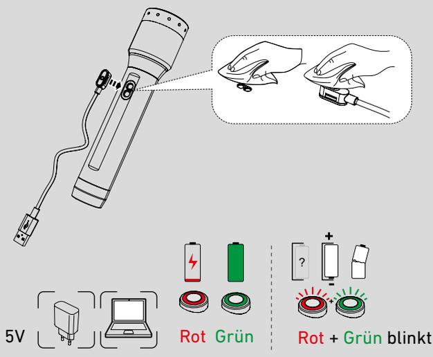
3. Während die Lampe geladen wird, leuchtet die Ladezustandsanzeige rot. Wenn der Ladevorgang abgeschlossen ist, wechselt die Anzeige auf grün. Sollte ein Fehler auftreten, blinkt die Ladeanzeige (z.B. defekter oder falsch eingelegter Akku).
