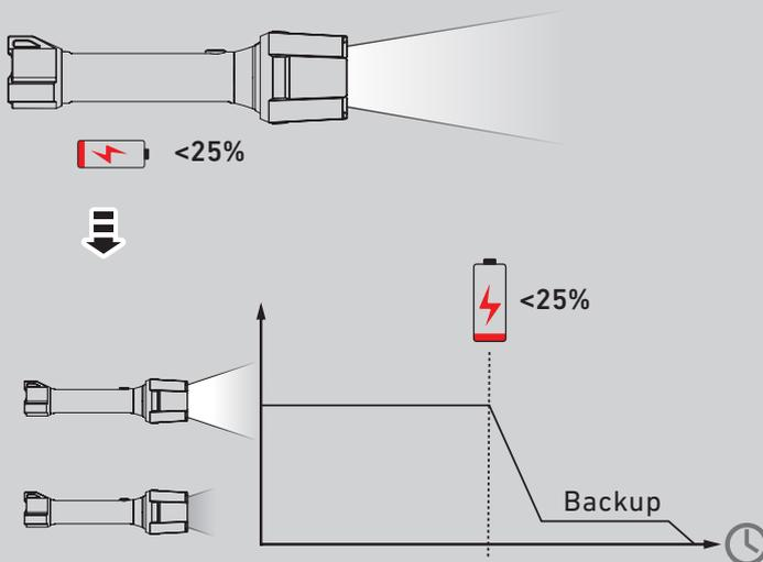
8. Bei niedriger verbleibender Akkukapazität – nach Ablauf der regulären Laufzeit – schaltet die Lampe in den „Backup Mode“. In diesem Modus kann die Lampe nur in der niedrigsten Helligkeitsstufe genutzt werden. Er verhindert ein plötzliches Ausschalten der Lampe und stellt sicher, dass der Anwender bei schwachem Akku weiterhin Licht zur Verfügung hat.
