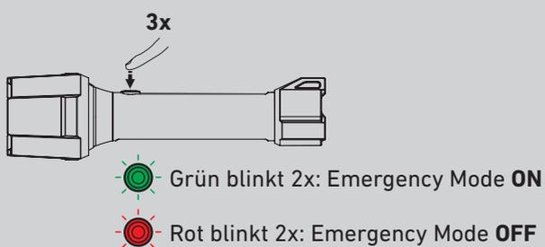
**10.** Mittels der erweiterten Einstellungen können Sie zusätzliche Funktionen ein- oder ausschalten. Schalten Sie hierzu die Lampe ein. Halten Sie den Schalter für ungefähr acht Sekunden gedrückt. Der Schalter blinkt zunächst einmal, anschließend zweimal. Lassen Sie den Schalter los, wenn er zweimal geblinkt hat.
