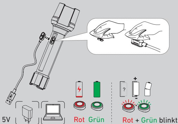
3. Während die Lampe geladen wird, leuchtet die Ladezustandsanzeige rot. Wenn der Ladevorgang abgeschlossen ist, wechselt die Anzeige auf grün. Sollte ein Fehler auftreten, blinkt die Ladeanzeige (z.B. defekter oder falsch eingelegter Akku).
