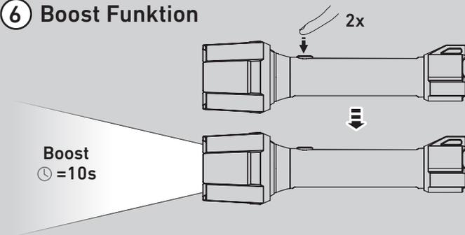
6. Im Boost-Modus leuchtet die Lampe mit der maximal möglichen Helligkeit für eine Dauer von zehn Sekunden. Der Boost Modus kann, außer bei eingeschalteter Tastensperre, jederzeit mit einem doppelten Antippen des Schalters aktiviert werden. Nach zehn Sekunden schaltet die Lampe in die zuvor ausgewählte Lichtfunktion zurück.
