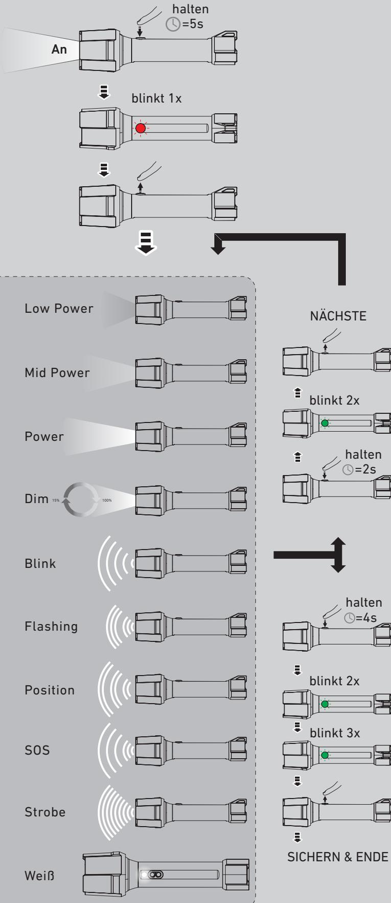
9. Die Taschenlampe ist mit ausgewählten Lichtfunktionen und Helligkeitsstufen voreingestellt. Falls Sie diese ändern wollen, so ist dies über den Schalter der Lampe möglich. Gehen Sie wie folgt vor:
