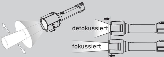
7. Verschiedene Aktivitäten erfordern unterschiedliches Licht. Durch leichtes Drehen und gleichzeitiges Vor- oder Zurückschieben des Lampenkopfes kann das Licht für maximale Leuchtweite fokussiert (gebündelt) werden oder für gleichmäßige Ausleuchtung des Nahbereichs defokussiert werden.
